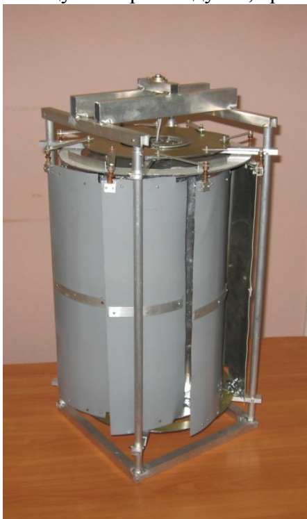
Лабораторный образец вихревой ветроэнергетической установки, работающей на малых скоростях ветра В-1
