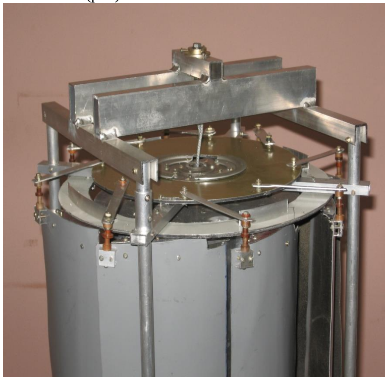
Лабораторный образец вихревой ветроэнергетической установки, работающей на малых скоростях ветра В-1
