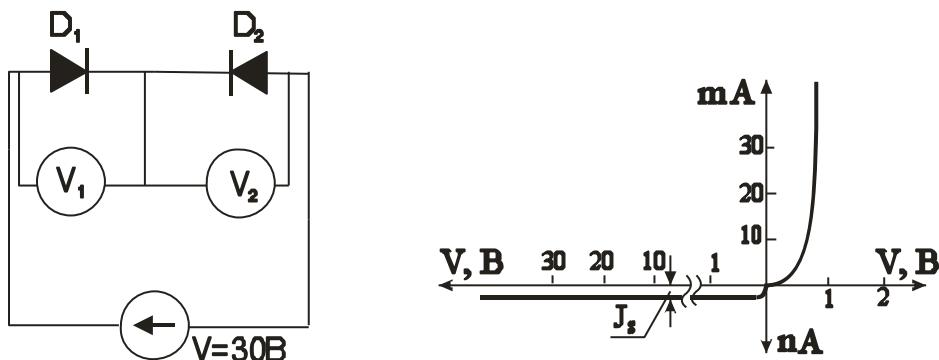
Оба диода тождественны и обладают одинаковыми вольтамперными характеристиками (см. рис.). Уравнение вольтамперных характеристик имеет вид:
