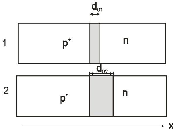
Дано: два  $p^+$ - $n$ -перехода с разными значениями толщины слоя объемного заряда в состоянии термодинамического равновесия  $d_0$ :  $d_{01} < d_{02}$
