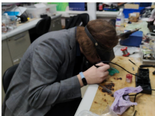
Рисунок 30 - Процесс пайки чипа
