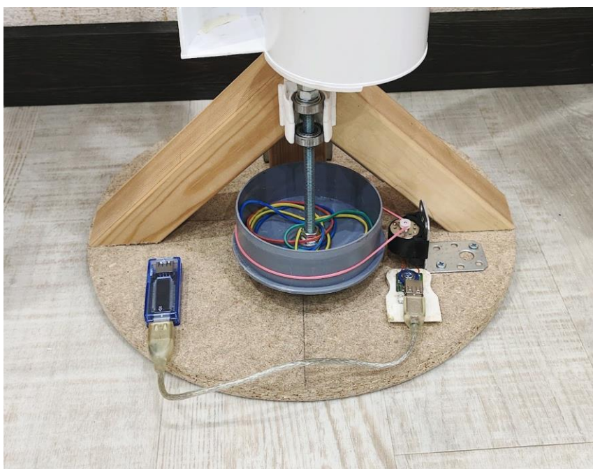
рис.12 соединение ротора с генератором
