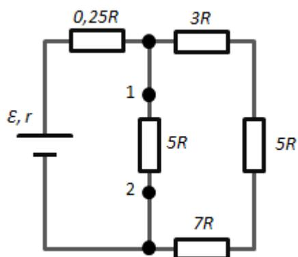
Пять резисторов с известным сопротивлением соединены в цепь, как показано на рисунке. К концам участка подключают источник с ЭДС, равной  $\mathcal{E}$ , сопротивление источника неизвестно. Сила тока на участке цепи между точками 1 и 2 равна  $3I$ .
