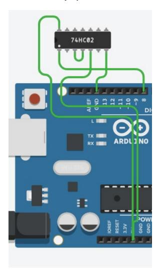
Дополнительно на входы 1А и 2В микросхемы подключить ползунковые переключатели. В коде программы реализовать следующий алгоритм: При высоком уровне на выводе 8
