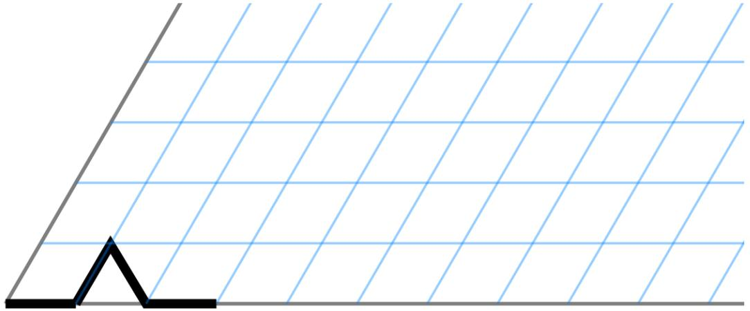
**Рис.4.** Первый шаг построения ломаной, генератор первого порядка.
