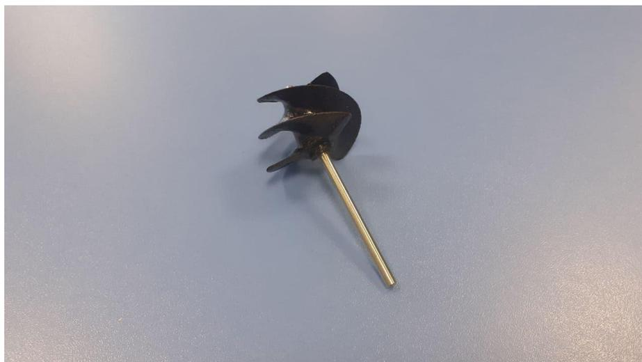
Рисунок 7. ИмPELLер шнекового типа для водомета.
