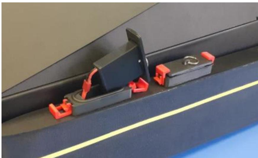
Рисунок 18. Блоки съемных аккумуляторных батарей.
