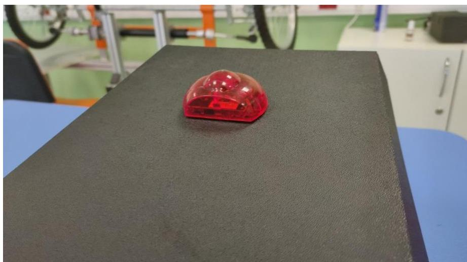
Рисунок 17. Светодиодный оповещатель, установленный на декоративном кожухе.
