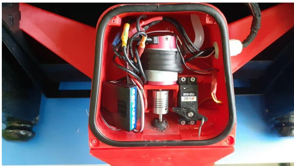
Рисунок 6. Корпус водомёта, созданный с применением аддитивных технологий.
