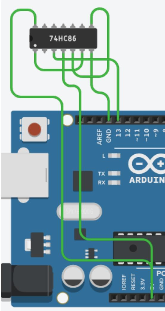
Дополнительно на входы 1В, 3А и 3В микросхемы подключить DIP-переключатели. В коде программы реализовать следующий алгоритм: При высоком уровне на выводе 13 Arduino, отнять от значения, подаваемого на светодиод значение 50, в противном случае – прибавить 50.
