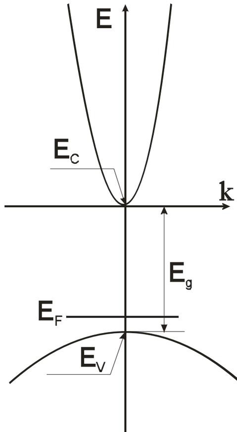
На рисунке изображены дисперсионные зависимости (зависимости полной энергии электрона  $E$  от волнового вектора  $k$  для зоны проводимости и валентной зоны) для гипотетического полупроводника. Температура полупроводника соответствует области истощения примеси.
