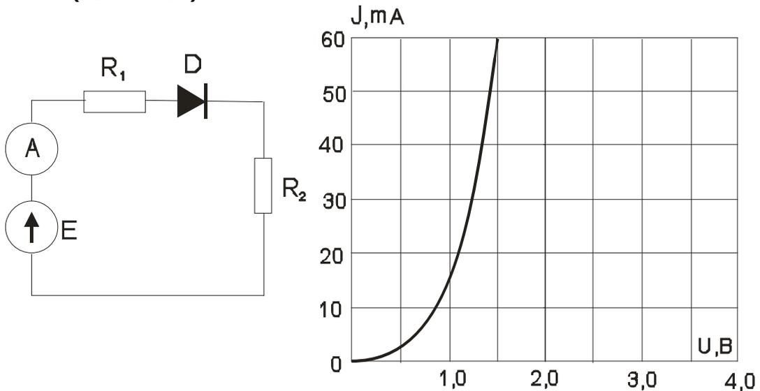
Дано:  $E = 4 \text{ В}$ ;  $R_1 = 20$ ;  $R_2 = 60 \text{ Ом}$  и график реальной вольтамперной характеристики диода.
