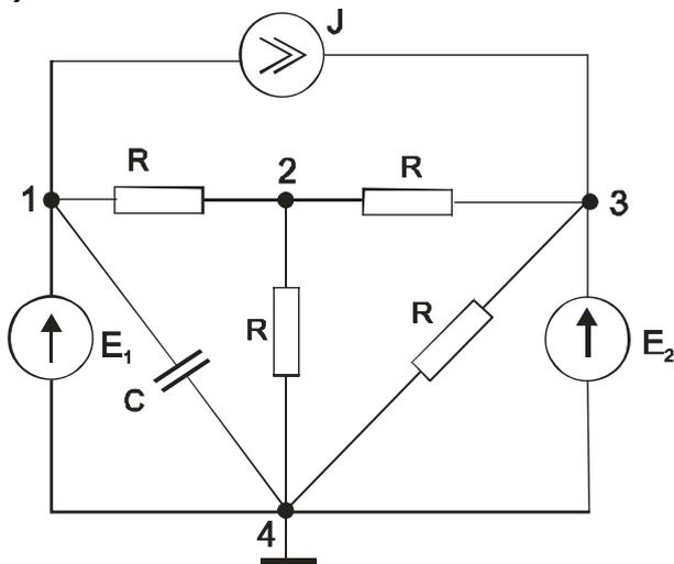
Дано:  $E_1 = 5$  В,  $E_2 = 20$  В, ток источника тока 2 А,  $C = 100$  пФ,  $R = 50$  Ом. Определить разность потенциалов между точками 3 и 4.
