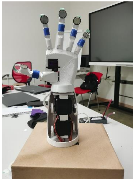
Рисунок 15. Система давления на протезе руки.
