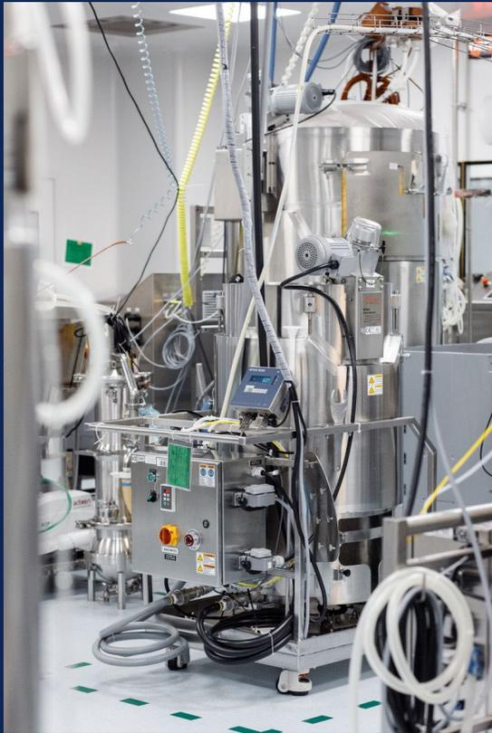
Стало. Емкости и трубопроводы из нержавеющей стали. Многоразовые технологии. Объем 12 куб. м.
