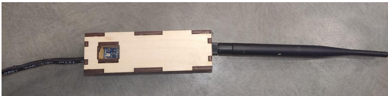
Рисунок 3 — Корпус с внешним датчиком температуры и влажности и радиомодулем
