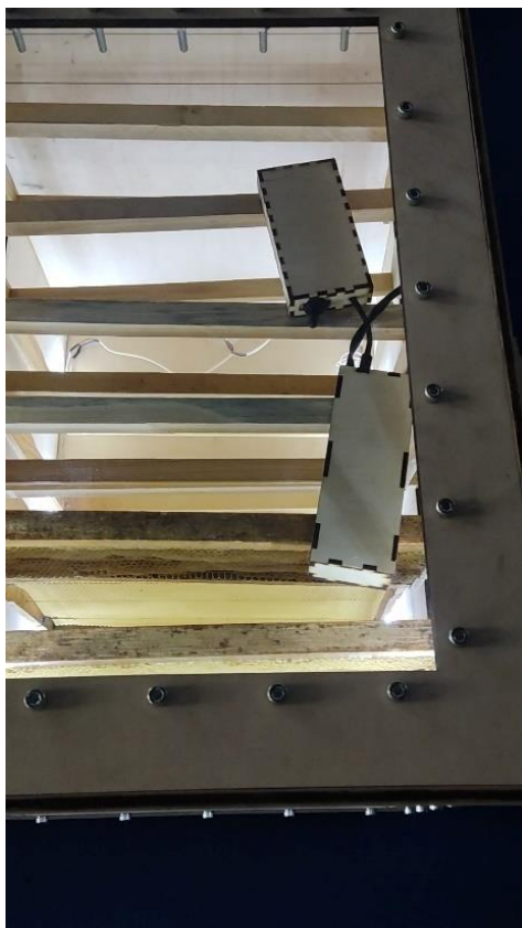
Рисунок 4 — Корпус с датчиками и микроконтроллером и аккумулятором на рамках внутри улья
