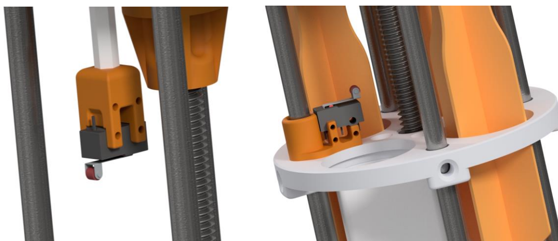
Рисунок 54 — Расположение механических концевых датчиков
