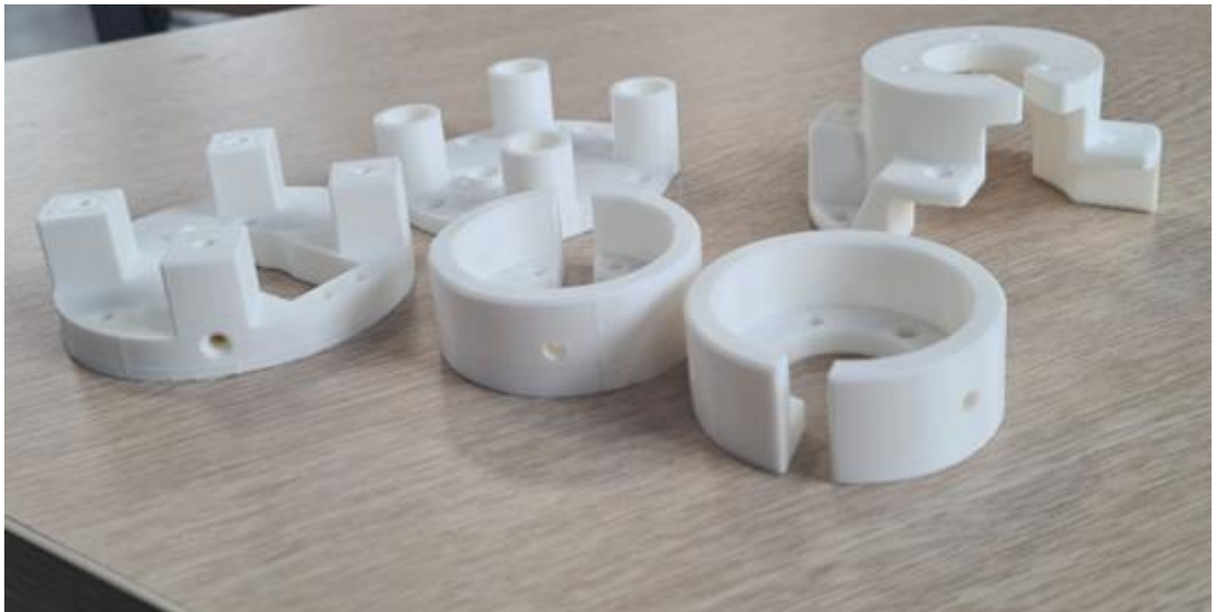
Рисунок 79 — Детали, изготовленные при помощи FDM-печати
