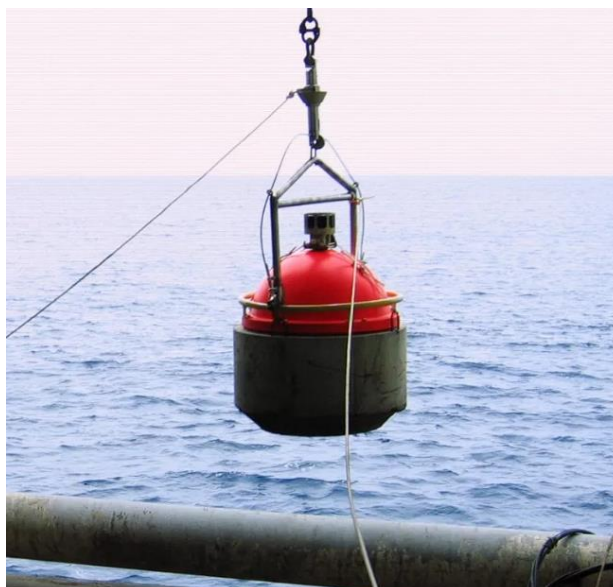
Рисунок 16 — Цифровая самовсплывающая донная сейсмостанция АДСС-1
