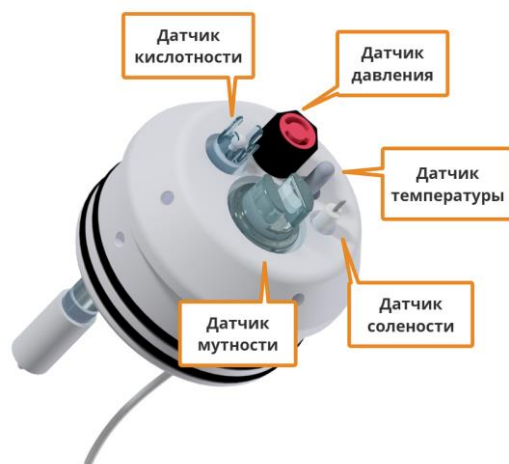
Рисунок 65— Расположение датчиков в верхнем обтекателе
