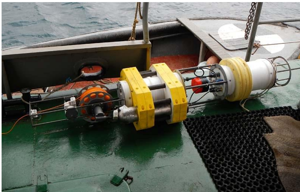
Рисунок 25 — Автономная позиционная измерительная станция «ПАГИС» циклирующего типа
