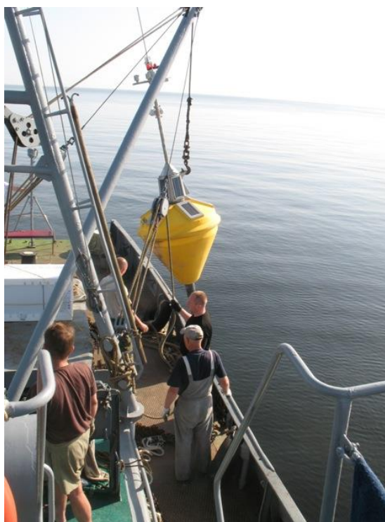
Рисунок 20 — Заякоренный гидрометеорологический буй, установленный в Финском заливе
