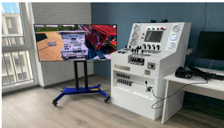
Рис. 1. Использование VR и точной копии системы управления (тренажер буровой установки)
