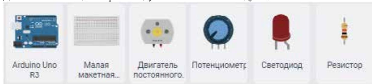
Необходимо в эмуляторе tinkercad собрать и запрограммировать макет дрели с индикацией. Индикация зависит от среднего количества оборотов в минуту мотора: при количестве оборотов до 2000 оборотов в минуту горит зеленый светодиод, от 2000 до 4000 желтый, после 4000 красный.
